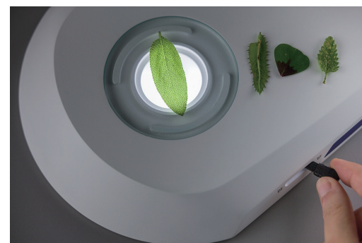
フラットな透過光ユニットは、明視野と暗視野が切替えられるので、色付きの透過性のあるサンプル観察に最適。オプションのポライザー／アナライザーフィルターを追加すると、複屈折結晶、ガラスやプラスチックの張力を観察できます。
