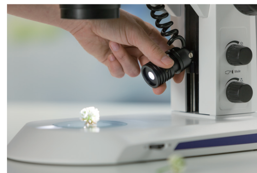
スポットの高さを変更し光束を絞ると、はっきりとした陰影が生まれ立体感のある3D像になります。最も低い位置ではグレーディング照明になり、強い陰影で平面上の微細な構造を強調できます。
