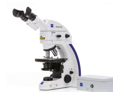
iLED蛍光光源は、Primo Star鏡基に組み込むだけで簡単にアップグレード可能です。
