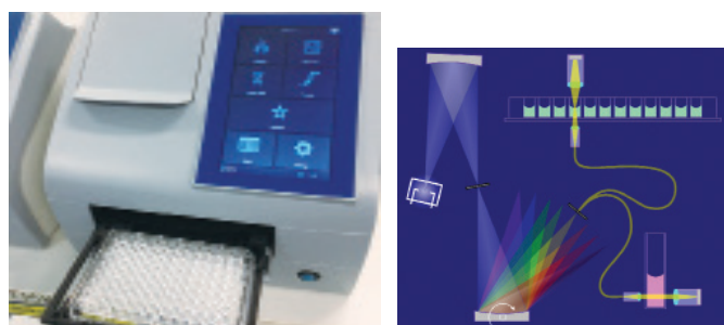
モノクロメーター内蔵で測定波長の選択が簡単
