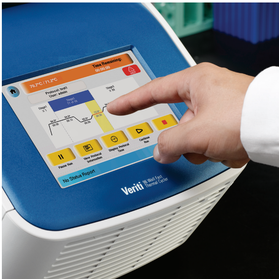
図 2 Veriti サーマルサイクラー搭載の 6.5 インチ VGA カラータッチスクリーン。
