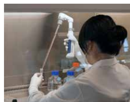
SP+ヘッドを伸ばして手元操作らくらく 特にクリーンベンチ・安全キャビネット内使用 時に快適性を発揮
