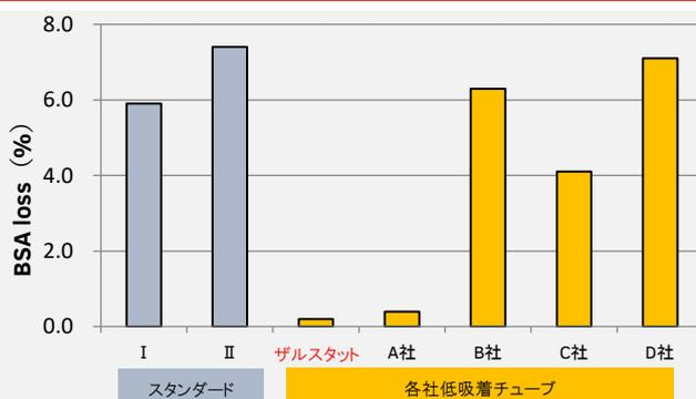
数社から集めた各10本のチューブを10 $\mu$ g/mlのBSA溶液で満たし、4 $^{\circ}$ Cで保存。24時間のインキュベーション後、BSA溶液を抽出して濃度をBradfordアッセイによって測定した。
