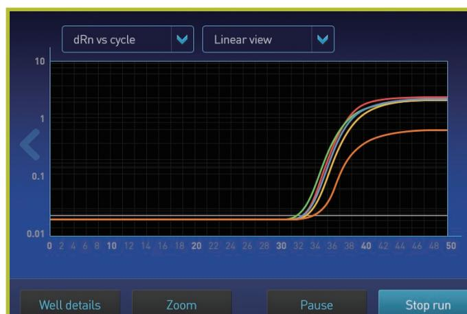
図1. インタラクティブ タッチスクリーン画面上で、サイクル条件 (A) の編集やプレートレイアウトを簡単に確認できます。また、ラン中にその増幅曲線 (B) やウェルごとの状況を確認できます。
